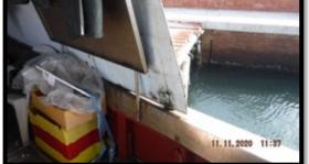
Dal piano di coperta, in evidente stato di carente manutenzione, sono visibili gli scalmotti sui quali poggia la falchetta, protetta da profilato in acciaio.
